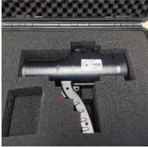
照片 2 X- $\gamma$ 剂量率仪
